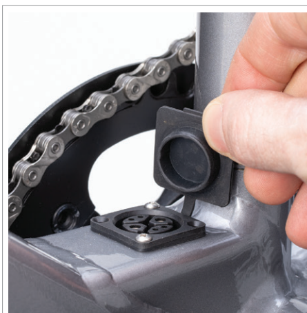
Apertura de la tapa del puerto de carga.
