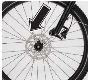
4B: Inserire il perno passante nel forcellino sinistro della forcella e nel mozzo della ruota.
